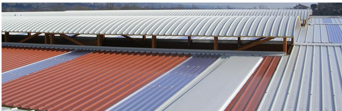
Panneau de toiture à âme en laine de roche et fixation apparente, constitué de 5 nervures d'une hauteur de 40 mm. La géométrie particulière de l'emboîtement du panneau assure une parfaite étanchéité. La face interne est perforée, conférant au panneau des propriétés d'isolation et d'absorption acoustiques. Disponible en divers revêtements, couleurs et finitions intérieures.
